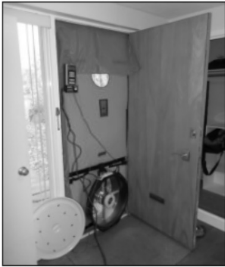
Blower Door Test
